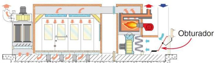
Durante as fases de cura e secagem, o operador fica fora da cabine e o sistema fecha a passagem do ar e recicla o ar interno, à fim de reduzir o consumo de energia.
