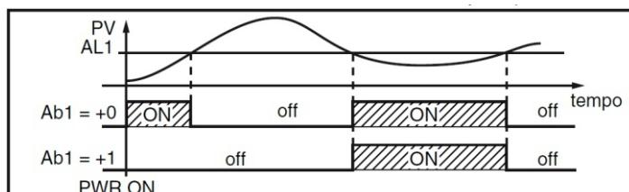
2. O alarme memorizado (reset manual) permanece ativo, mesmo que as condições que o geraram desapareçam. O reset do alarme só poderá ser feito por um comando externo (tecla , entradas digitais ou pela comunicação serial).
