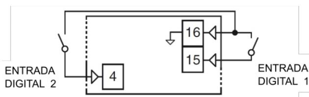
Máxima resistência do contato: 100Ω
