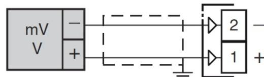
**Impedância da entrada:** > 1 MΩ para entrada em mV
