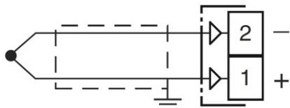
**Resistência externa:** máximo 100 Ω, erro máximo 25 µV.
