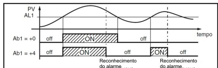
4. O alarme relativo não acionado durante alteração do set point desconsidera as condições de alarme na mudança do set point até que o processo atinja o valor programado.
