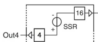
**Nível lógico 0:**  $V_{saída} < 0.5 \text{ Vcc}$
